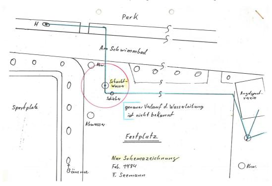
An den bestehenden Überflurhydrant wurde die neue Leitung angeschlossen und im Weiteren bis zu den Hauszuleitungen erneuert.
