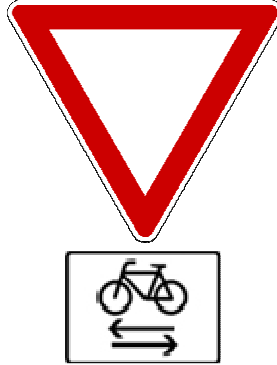
Zeichen 205: Vorfahrt gewähren. In Kombination mit Zusatzzeichen 1000-32 (Auf kreuzenden Radverkehr von links und rechts achten).
