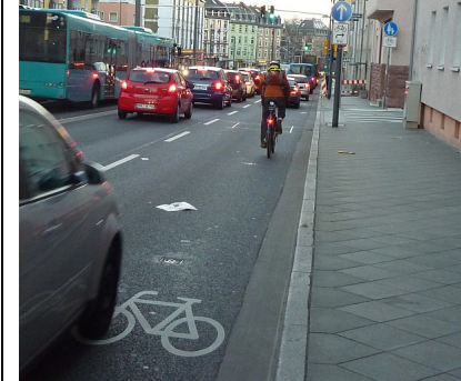
Beispiel für Markierung von Fahrradpiktogrammen für höhere Akzeptanz des Radfahrers im Mischverkehr
